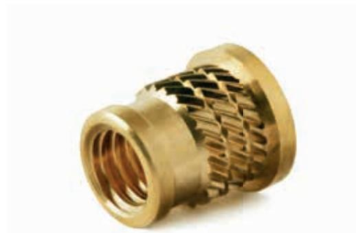
**SPIRO** è stato progettato per affrontare le difficoltà poste dai materiali termoindurenti duri e fragili. Il disegno di precisione a spigoli vivi della zigrinatura consente all'inserto di tagliare la propria sede in questi materiali, riducendo le tensioni radiali e
